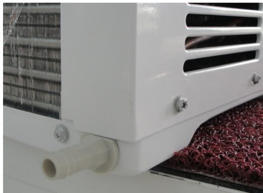
**IMPORTANTE:** Ao encaixar a caixa externa do produto, tomar cuidado com a conexão de drenagem, pois a caixa externa pode não encaixar perfeitamente, com isso você terá que cortar a conexão de drenagem conforme figura abaixo. A conexão de drenagem deve ser reta, sem curvas, não devem ser utilizados cotovelos, pois ao posicionar o produto o cotovelo pode trancar no suporte e danificá-lo.
