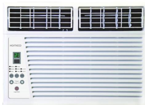
Informamos que nossos produtos da linha compacto modelo KOJ07FCLX, KOJ09FCLX e KOJ12FCLX não possuem orifício para instalação da conexão de drenagem, pois o produto foi desenvolvido para armazenar o condensado em sua bandeja e através do movimento giratório do ventilador, impulsionar o condensado sobre o trocador de calor (condensador), aumentando sua eficiência devido a evaporação da água.
